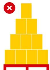
**Evita que las cajas sobresalgan del pallet** ya que pueden sufrir daños durante el manipulado y reducir su resistencia. Apila las cajas en columnas, de esquina a esquina, para que sean resistentes. Puedes estabilizar y asegurar el pallet usando fleje o film retráctil.
